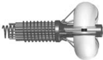
Afbeelding 2. Het 'donut'-mechanisme voor aandrijving van een endoscooptip.
