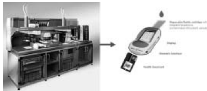
Afbeelding 3. Een 'lab-on-a-chip' (computeranimatie) kan een omvangrijke chemische laboratoriumopstelling vervangen.
