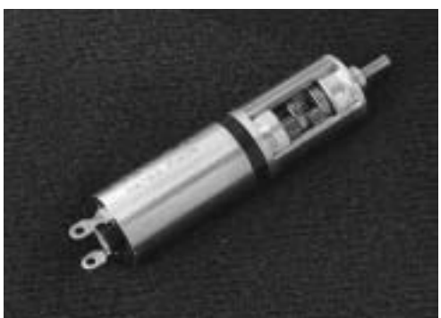
Figuur 5. Micromotor met geïntegreerde reductie-'kast'.
