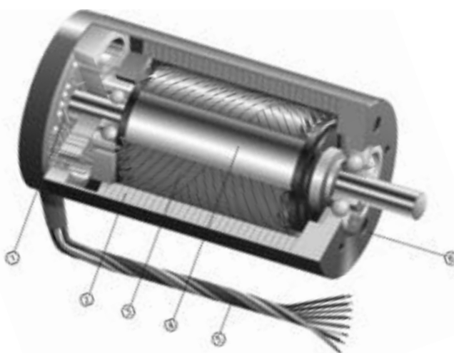
Figuur 4. Exploded view van borstelloze motor met geïntegreerde elektronica: printplaat met Hall-sensoren (1), behuizing met lamellenpakket (2), spoel met schuingewonden wikkelingen (3), rotor (4), aansluiting met de aandrijfelektronica (5) en voorzijde van de behuizing met montagegemogelijkheden (6).
