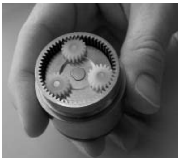
Figuur 8. Toerentalreductie door middel van een planeetwielen-overbrenging.
