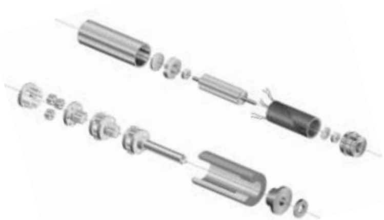
Figuur 7. Exploded view van een microaandrijfsysteem bestaande uit een borstelloze DC-micromotor en een planetaire reductiekast; de besturingselektronica is ondergebracht in een afzonderlijke unit.
