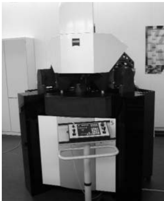
Afbeelding 2. De coördinatenmeetmachine Zeiss F25 is ontworpen voor het meten van kleine producten.
