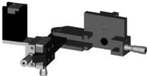
Figuur 6. Ontwerp electro-sprayunit (inspectie positie)
