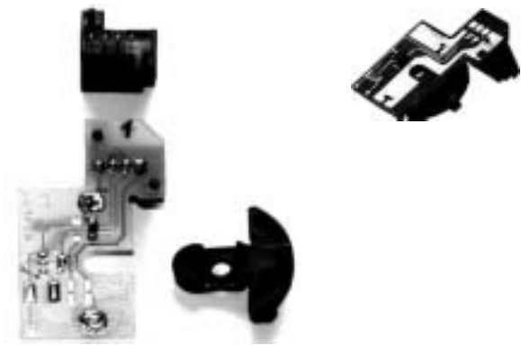
Afbeelding 2a: Steun voor een servomotor in klassieke uitvoering en verschillende onderdelen.
