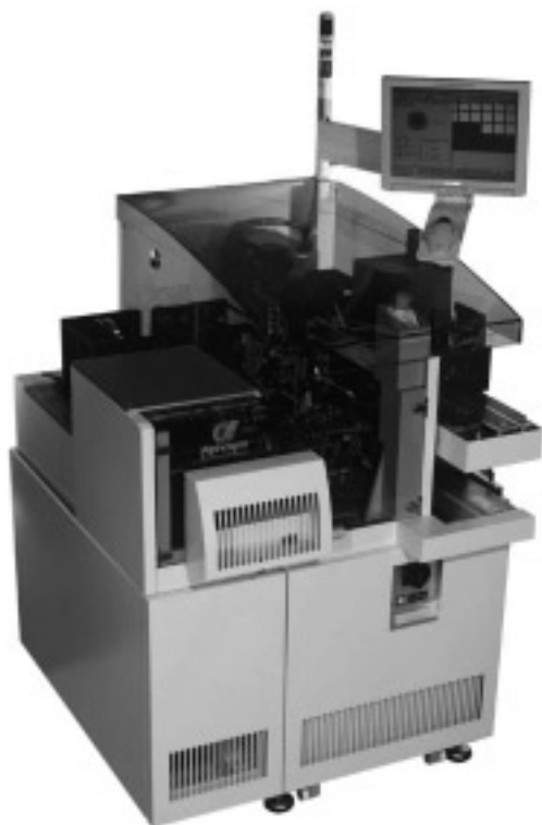
Afbeelding 7. De chip-montagemachine Easyline 8032 van Alphasem AG
