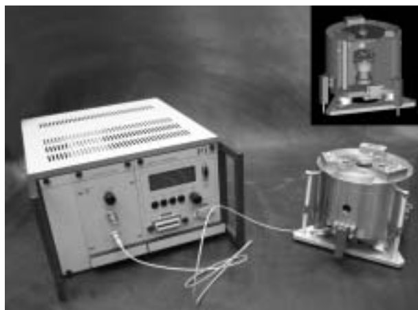
Afbeelding 4. Foto van de kleine Fabry-Perot cavity in de inzet een schematische weergave van het ontwerp
