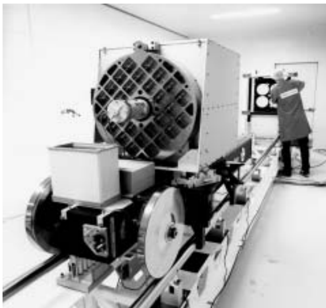
Afbeelding 5. Delay Line bij Dutch Space in de Clean Room (foto: Dutch Space/TNO TPD)
