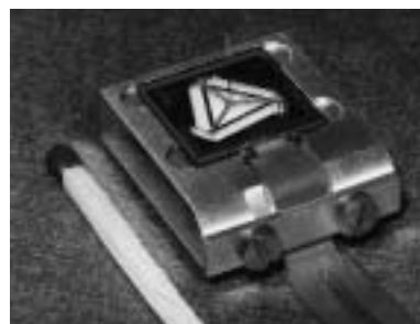
Afbeelding 15. De door de TU Eindhoven ontworpen 1 nm-taster met piëzo-elektrische rekstrookjes en een kogeldiameter van 250 \mu\text{m} .
