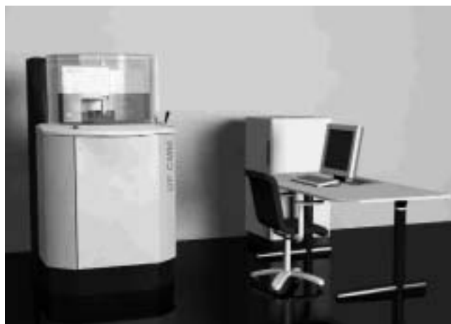
Afbeelding 1. IBS Precision Engineering claimt dat zijn meetmachine ISARA de nauwkeurigste niet-laboratoriummachine ter wereld is.
