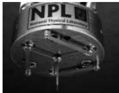
Afbeelding 14. De capacitieve taster van NPL met een kogeldiameter van 150 \mu\text{m} .
