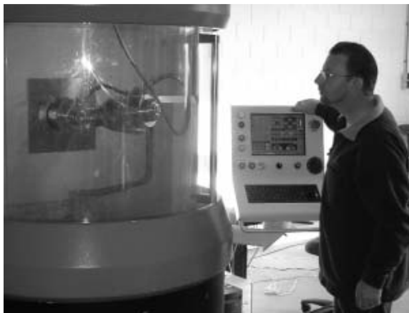
Afbeelding 7. De polijstrobot van Zeeko waarop TNO het 'fluid jet'-polijstproces heeft geïmplementeerd, samen met de deflectometer van Vision Dynamics.
