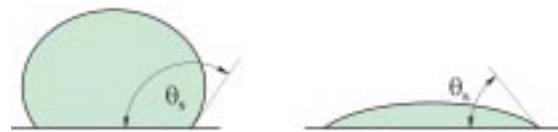
Effect van de contacthoek tussen druppel en oppervlak op de waterafstotendheid ervan
