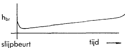
Figuur 12 Braamhoogte in de tijd na een slijpbeurt van het gereedschap.
