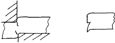
Figuur 11 Extrusiebraam bij te kleine snijspleet.
