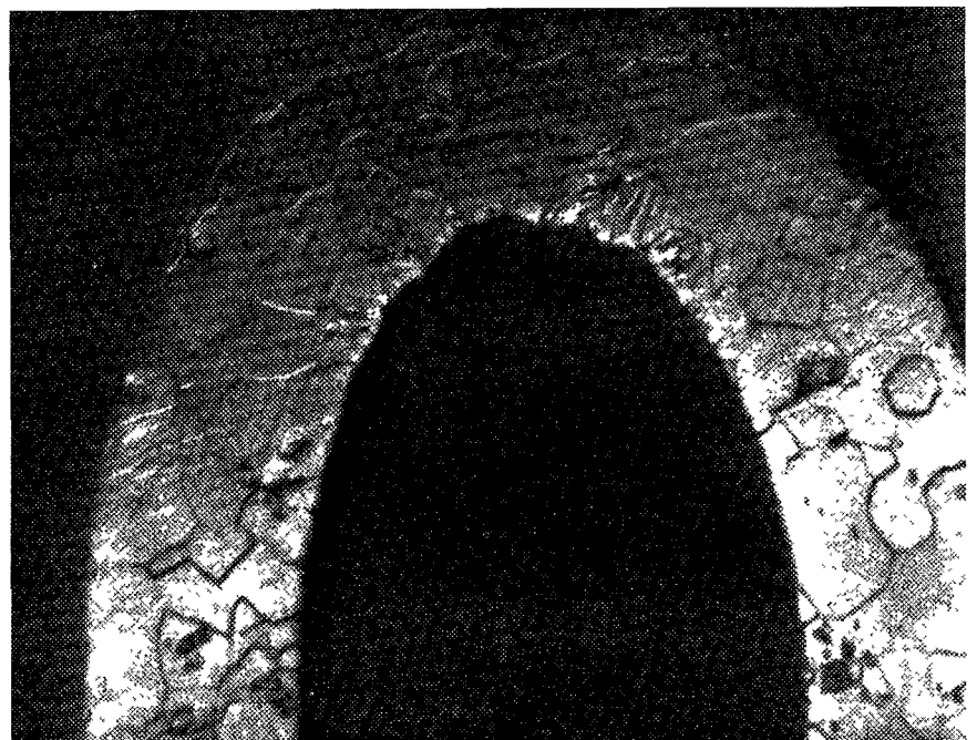
Figuur 1 Gebogen magneetplaat, t = 0,5 \text{ mm} , vergroting 52 maal. Hier is duidelijk de vervorming van een aantal kristallieten te zien.
