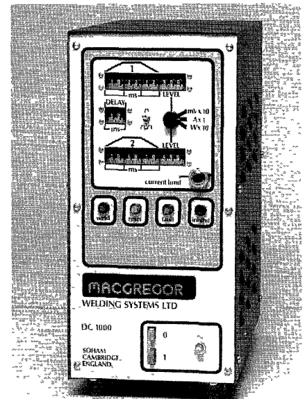
Figuur 4. Standaard DC-lasbron met: - aanlooptijd, pulsduur, en aflooptijd in stappen van 1 ms; - enkel- of dubbele puls mogelijkheid; - stroom, spanning of vermogen gestuurd; - maximum stroom 1000, 1800/2400, 3500, 5000 A of groter.
