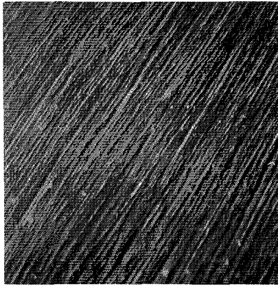
Figuur 6. Microscopische opname van een speciaal geslepen monster BK7-glas. Differentiaal-interferentiecontrast volgens Nomarski, loodrecht op de structuur in de ruwheid. Microruwheid 3,2 nm rms, breedte van het beeld 500 \mu\text{m} .
