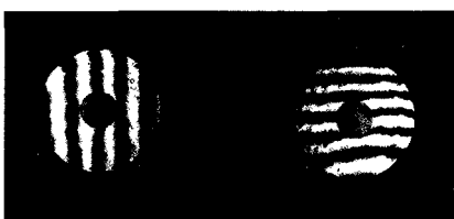
Figuur 6. Interferentiebeeld van een asferische Schmidt-plaat.
