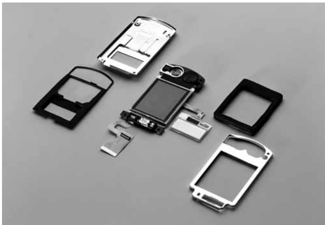
Afbeelding 6. De componenten van een PolyLED-display voor de Sensotec.
