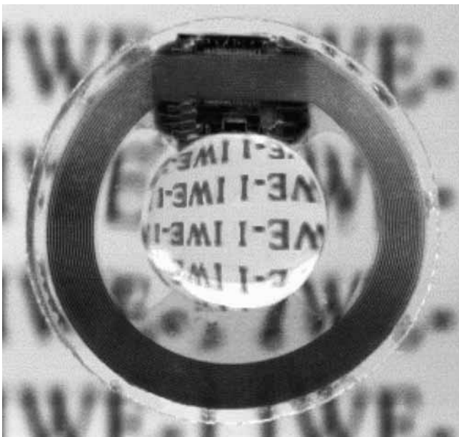
Afbeelding 1. Een intra-oculaire Acri.Tec kunstlens met geïntegreerde druksensor.
