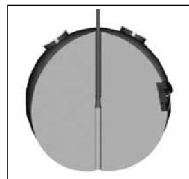
Afb. 7. Ophanging van de bol met daarop de verplaatsingsopnemers.
