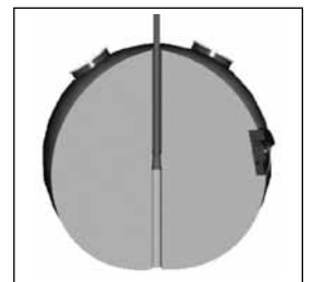
Afb. 7. Ophanging van de bol met daarop de verplaatsingsopnemers.
