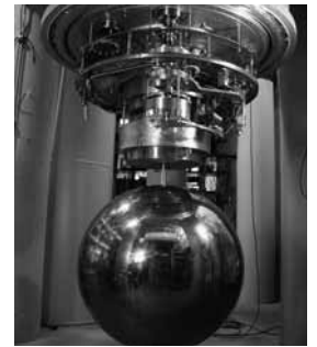
Afb. 6. Foto van de bol hangend aan de trillingsdempers, met daarboven de mengkoelmachine.
