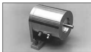
Figuur 9. Luchtgesmeerde, wrijvingsloos werkende perslucht cilinder, zuigerdiameter 50 mm, toevoerdruk 6 baro, radiale belasting tot 500 N, lagerspleet 10 \mu\text{m} , luchtverbruik gaslager 5 liter/min. Totaal luchtverbruik perslucht cilinder bij maximale aandrukkraft van 1200N, 10 liter/min.
