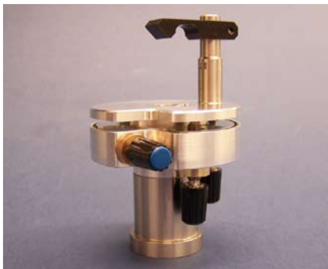
Afbeelding 1. Voor een tentamen in het derde jaar moet de LiS-leerling een werkstuk werkend opleveren. Hier een steltafel (gimbal mount) voor een prisma.
