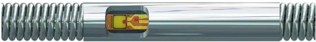
Afbeelding 4. Een computeranimatie van de sensor in de catheterdraad van Afbeelding 3.
