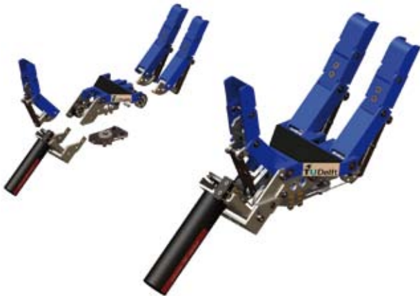
Figuur 3. 3D CAD-model van de subsamenstelling en samenstelling van de robothand.
