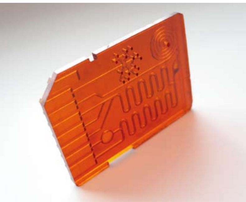
Een testsample van een micro-fluidisch systeem zo groot als een SD-card.
