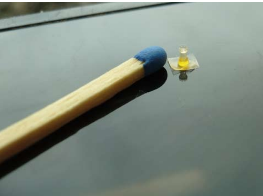
Een schaaktoren met een inwendige wenteltrap. Hoogte 2,8 mm, detaillering van 4 µm.
