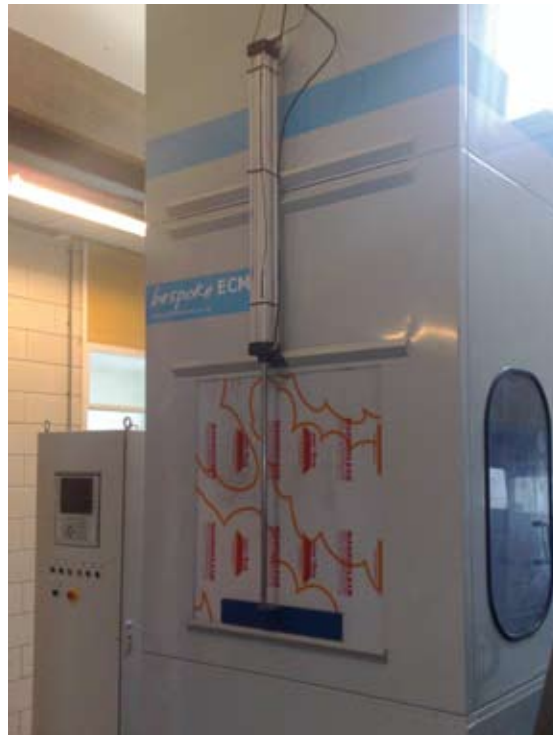
Afbeelding 6. Klantspecifiek ontwikkelde ECD-boormachine (Foto: ECM Technologies)
