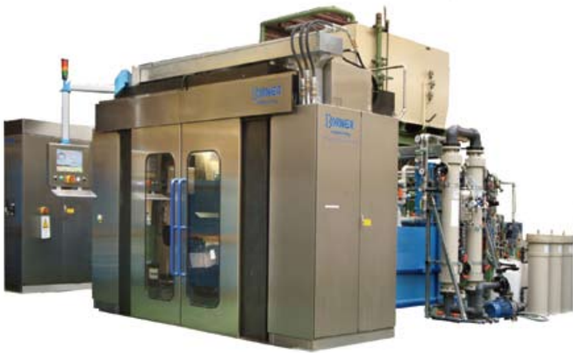
Afbeelding 8. Nieuwste 5-assige Bliks-machine, voor het maken van een turbine-wiel uit één stuk. (Foto: DK-Tec)
