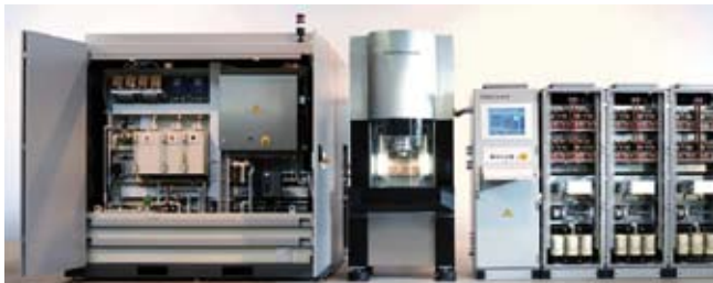
Afbeelding 5. Universeel PEMcenter; in het midden de mechanica, links het elektrolytstelsel, rechts de pulsgenerator. (Foto: PEMTec)
