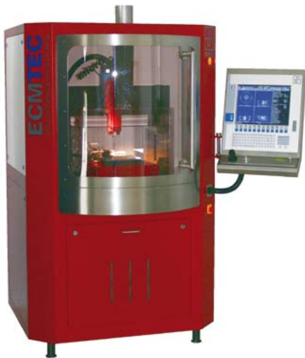
Afbeelding 10. Speciaal voor ECF ontwikkelde 'Mikro' bewerkingsmachine. (Foto: ECMTEC)
