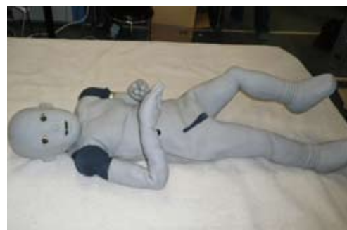
Afbeelding 4. Robot CB 2 vertoont de natuurlijke bewegingspatronen van een klein kind. CB 2 is aan Osaka University ontwikkeld in het kader van het Erato (Exploratory Research for Advanced Technology) programma van de Japan Science and Technology Agency, JST ( www.jeap.org/web ). (Foto: Dannis Brouwer)
