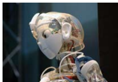
Afbeelding 9. De originele ontwerpaanpak voor de musculo-skeletale humanoid Kotaro was gericht op het realiseren van flexibiliteit en 'lichtheid' in de bewegingen van de robot ( www.jsk.t.u-tokyo.ac.jp ).
