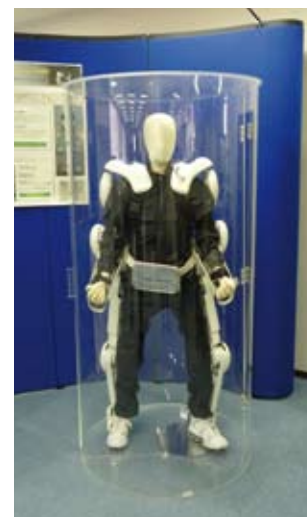
Afbeelding 11. Het exoskelet robotpak HAL (Hybrid Assistive Limb), voor ondersteuning van bijvoorbeeld revalidatie, reddingswerk of ander zwaar werk. HAL wordt op de markt gebracht door Cyberdyne, een spin-off van University of Tsukuba ( www.cyberdyne.jp/english ).
