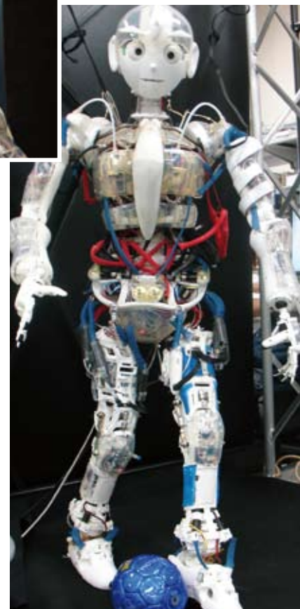
Afbeelding 9. De originele ontwerpaanpak voor de musculo-skeletale humanoid Kotaro was gericht op het realiseren van flexibiliteit en 'lichtheid' in de bewegingen van de robot ( www.jsk.t.u-tokyo.ac.jp ).
