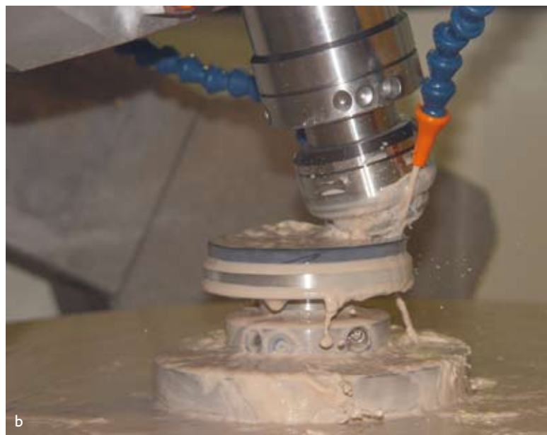
b) Lokaal materiaal verwijderen met 'bonnet polishing'.
