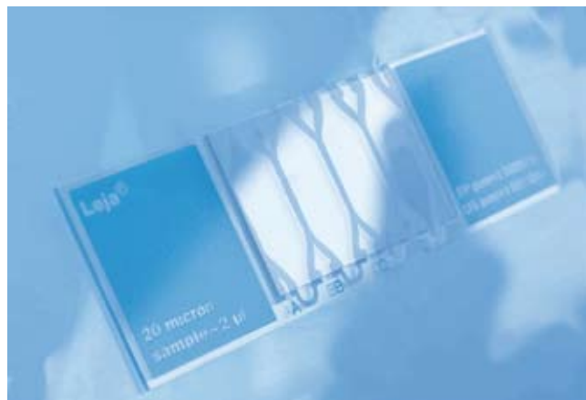
Afbeelding 11. De telkamer van glas met een monsterkamer van 10 à 100 µm hoog, waarvoor TNO een alternatieve microstructuur in kunststof ontwikkelt.
