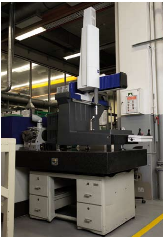
Afbeelding 6. DuraMax variant op een granieten meettafel.
