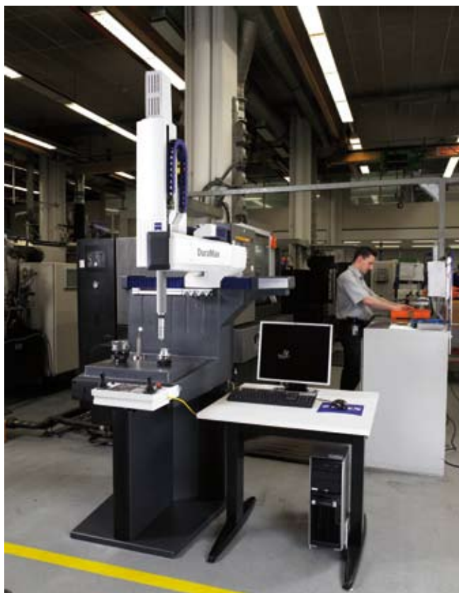
Afbeelding 4. Meetopstelling bedoeld voor directe inzet in productieruimtes.
