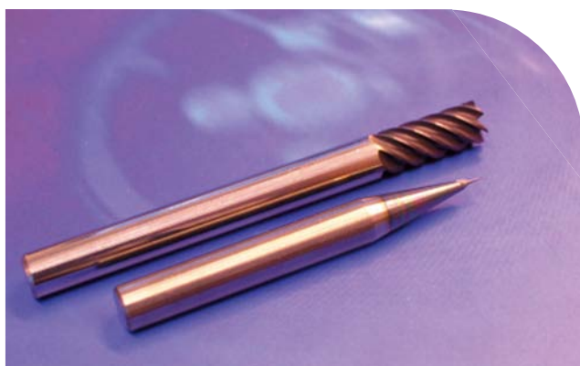
Twee frezen, links met een diameter van 6 millimeter, rechts een microfrees (0,5 mm)
